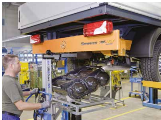
Einbau von Erdgas-Tanks (Mercedes Benz Sprinter)
