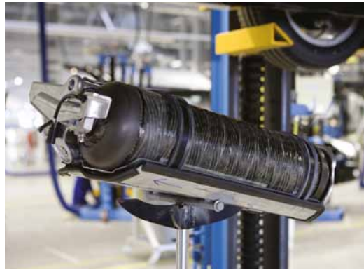
Einbau von Erdgas-Tanks (Mercedes Benz B-Klasse)
